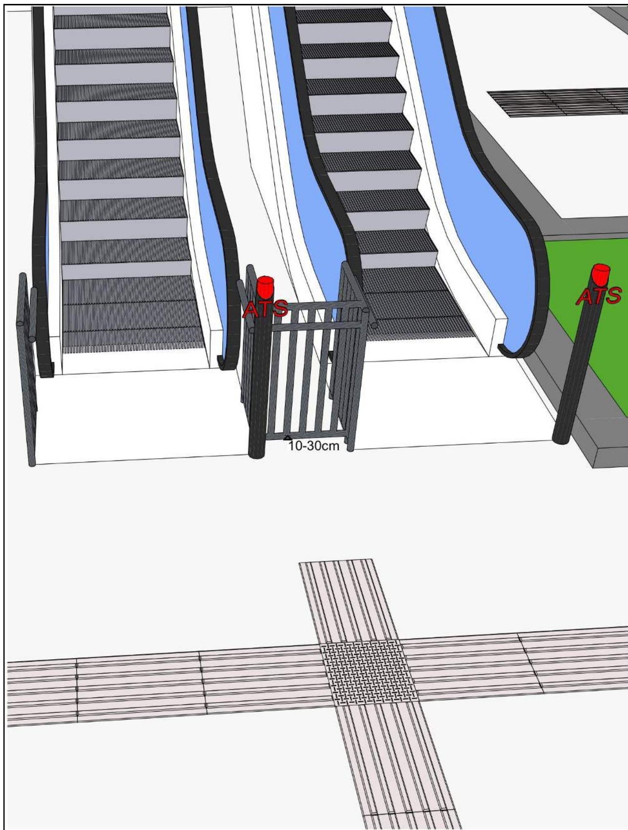
45. ábra: mozgólépcsők TWSI jelzése általános esetben, 3D
